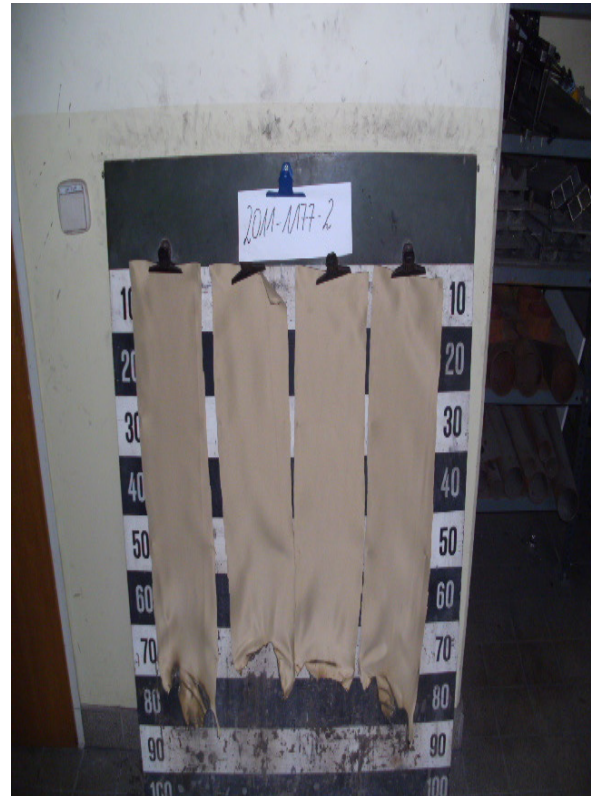
Aussehen der Probe B nach dem Brandschachtversuch
