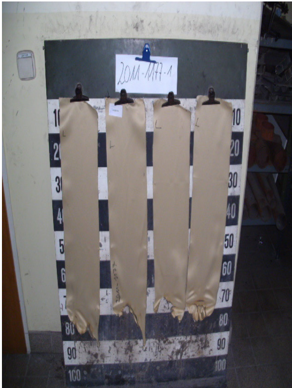
Aussehen der Probe A nach dem Brandschachtversuch
