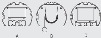
A: Für Elektrozug-System 5300 (mit Montageprofil 4117 und Distanzstück 4145).
